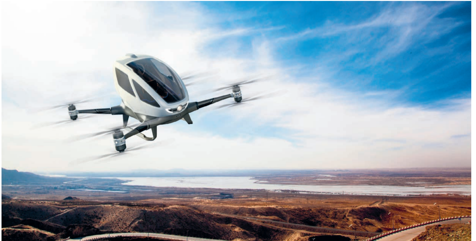
De Ehang 184 kan een passagier van honderd kilo vervoeren, 23 minuten lang en met een snelheid van ruim honderd kilometer per uur.
